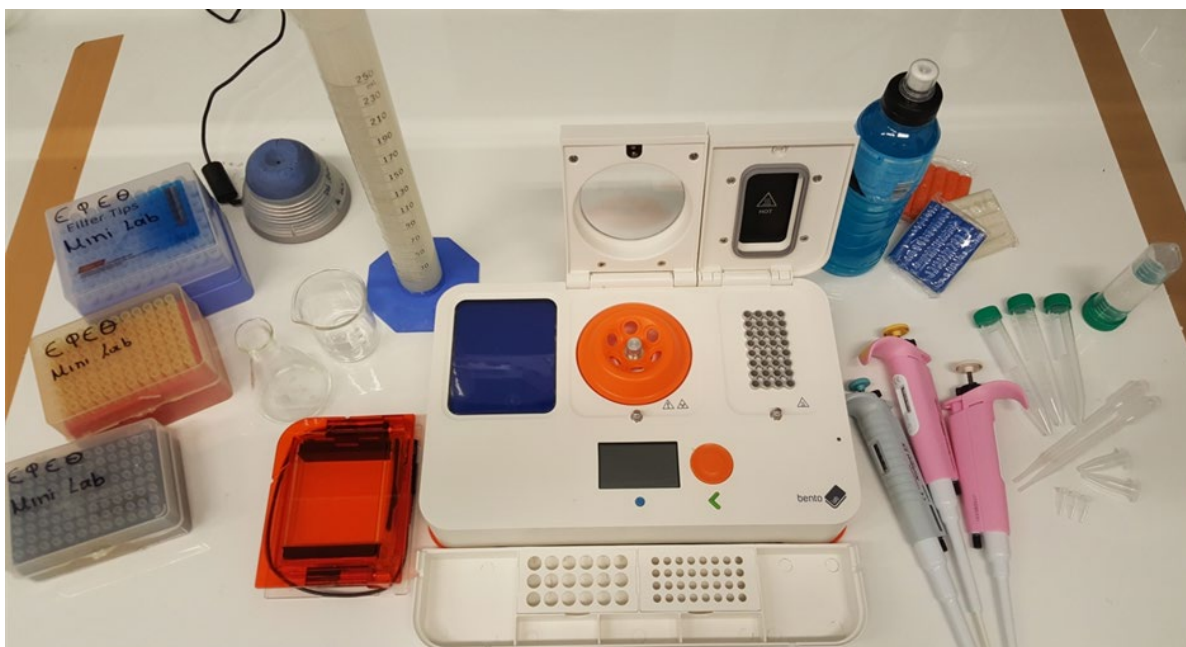
Εικόνα 1. Το φορητό εργαστήριο μοριακής βιολογίας 2MoBiL. Η συσκευή περιλαμβάνει θερμικό κυκλοποιητή, φυγόκεντρο, συσκευή ηλεκτροφόρησης, καθώς και τράπεζα οπτικοποίησης του τελικού αποτελέσματος. Τη συσκευή συνοδεύουν ρυθμιζόμενες πιπέττες ακριβή όγκου, πλαστικός ογκομετρικός σωλήνας, κωνική φιάλη, ποτήρι ζέσεως, στροβiloαναδευτήρας, εστία θέρμανσης και τράπεζα οπτικοποίησης Blue LED, πλαστικά ακρορύγχια μιας χρήσης, αυτοπωματιζόμενα σωληνάρια πολυπροπυλενίου, βιδωτού πωματισμού ακρυλικοί δοκιμαστικοί σωλήνες και όλα τα απαραίτητα αναλώσιμα για τη διεξαγωγή των πειραμάτων των πέντε εργαστηριακών φάσεων. Το φορητό εργαστήριο είναι κατάλληλα σχεδιασμένο για εύκολη και γρήγορη μεταφορά.
