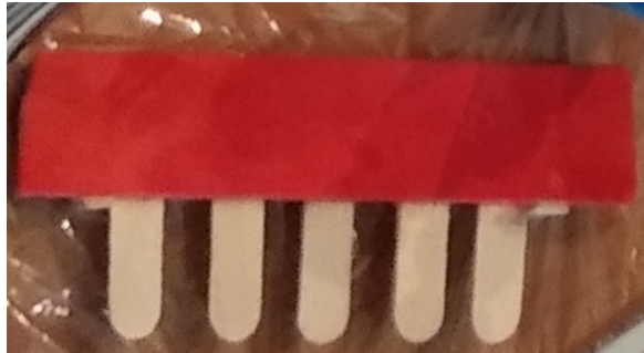
Εικόνα 2. Η κατασκευή για το χτένι. Τα δύο ακραία κάθετα λευκά ξυλάκια (Ξ1) τοποθετήθηκαν για να σταθεροποιείται η κατασκευή. Για ηλεκτροφόρηση θα χρησιμοποιηθούν τα πηγαδάκια που θα σχηματιστούν από τα τρία κεντρικά ξυλάκια. Τα 5 Ξ1 έχουν τοποθετηθεί μεταξύ των 2 Ξ2, πάνω στα οποία έχουν κολλήσει με κόλλα γενικής χρήσης.
