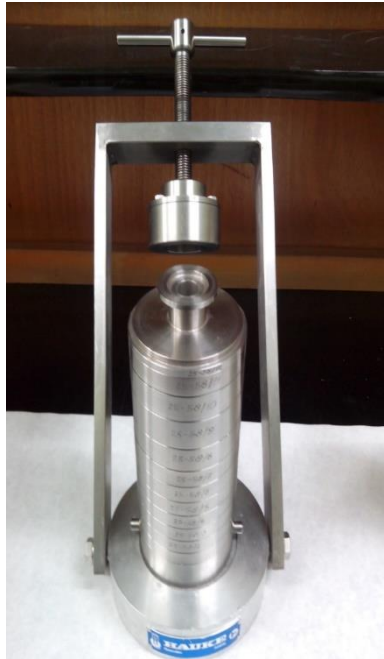
Εικόνα 2. Αδρανειακός συλλέκτης πολλαπλών σταδίων
